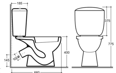
Допускается отклонение габаритных размеров ± 3% / Overall dimensions may vary ± 3%.
